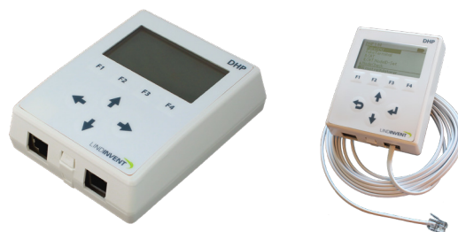
DHP - Håndholdt brugerpanel med støtte for både trådløs og kablet opkobling.
