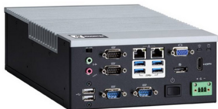
Ebox640-500-FL for system med opptil 1000 noder.
