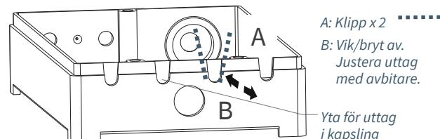
[2:2] Gör uttag i kapsling för kablage: LCX och RCX. Använd avbitartång för att [A] öppna lämpligt uttag i kapsling och för att [B] trimma uttag.
