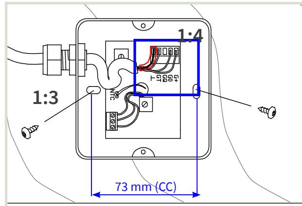
[1:3] Orientera GT-D för infästning i längsrikningen av kanalen. Dra skruvar tills tätning sluter tätt.
