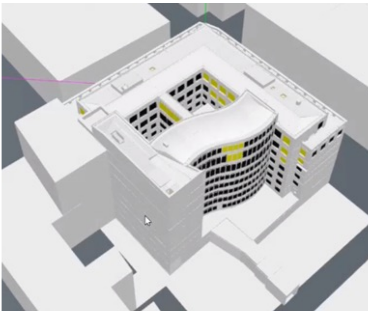
Skuggberäkning med beräkningsmodulen ShadeCalc.
